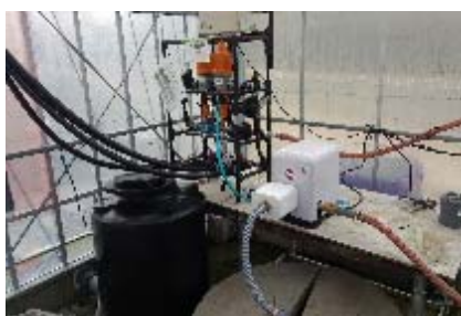
日射と土壌水分を連動した自動かん水装置
